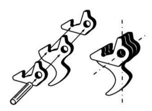
Чтобы выровнять склеиваыемые детали, вставьте шкант в отверстие
